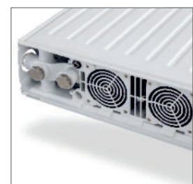
Eingreifsichere Lüfter auf Unterseite
