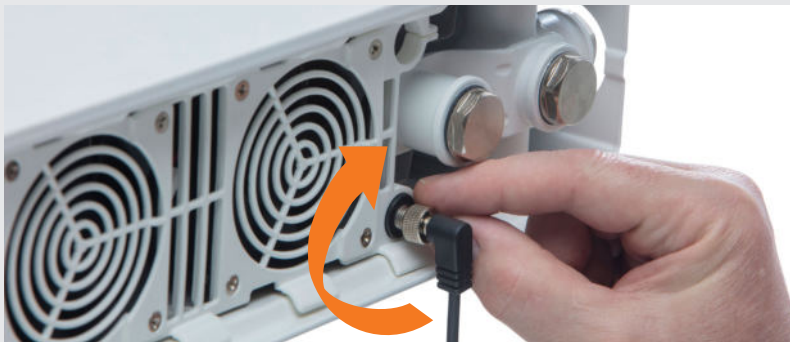
Abbildung 10: Hohlbusstecker einstecken und verschrauben
